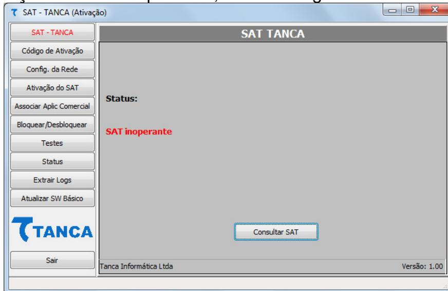
Neste caso verifique se o SAT está devidamente conectado, se o SAT já terminou a inicialização corretamente ou se os Drivers foram devidamente instalados.
